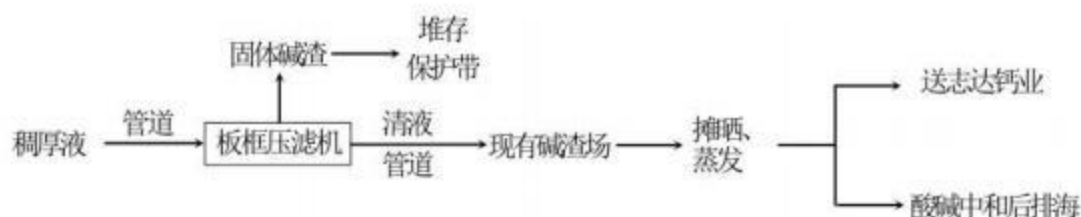
图 3.2-8 碱渣产生的工艺流程图
