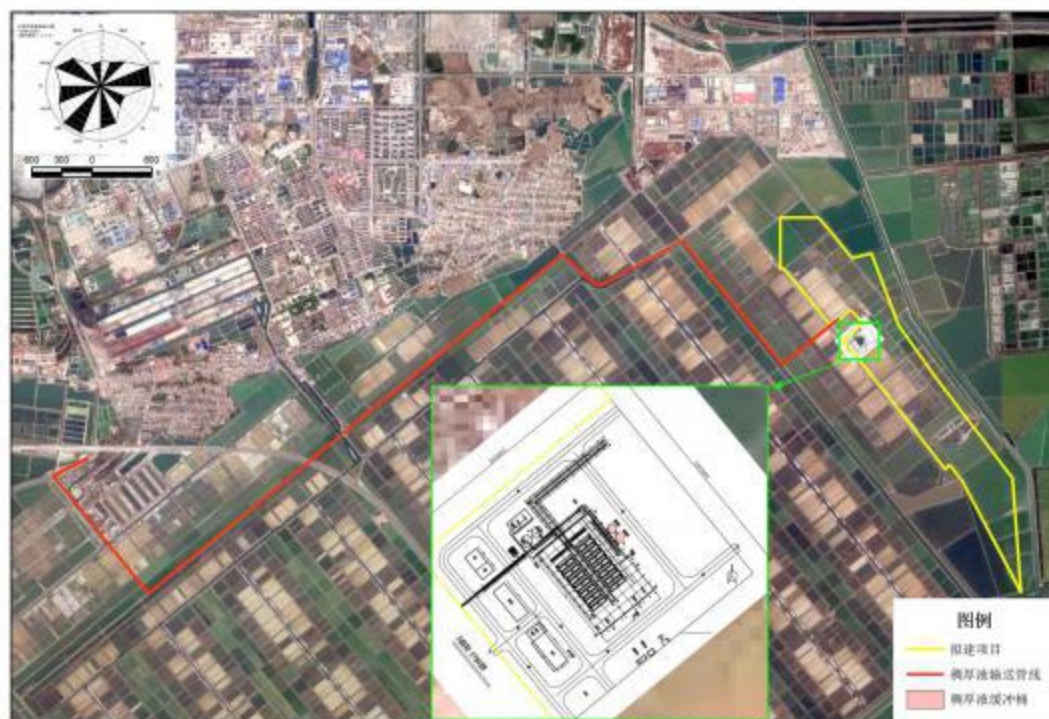
图 6.8-1 稠厚液输送管线及缓冲桶位置图
