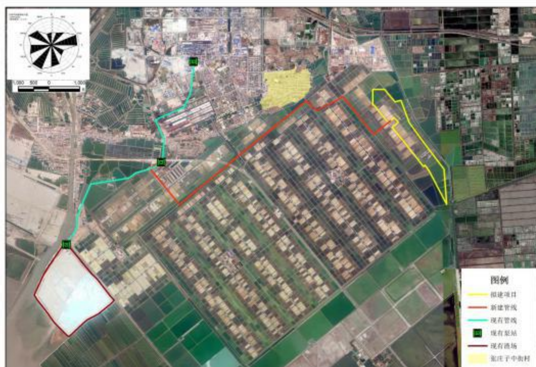
图 3.2-13 本项目管线走向图
